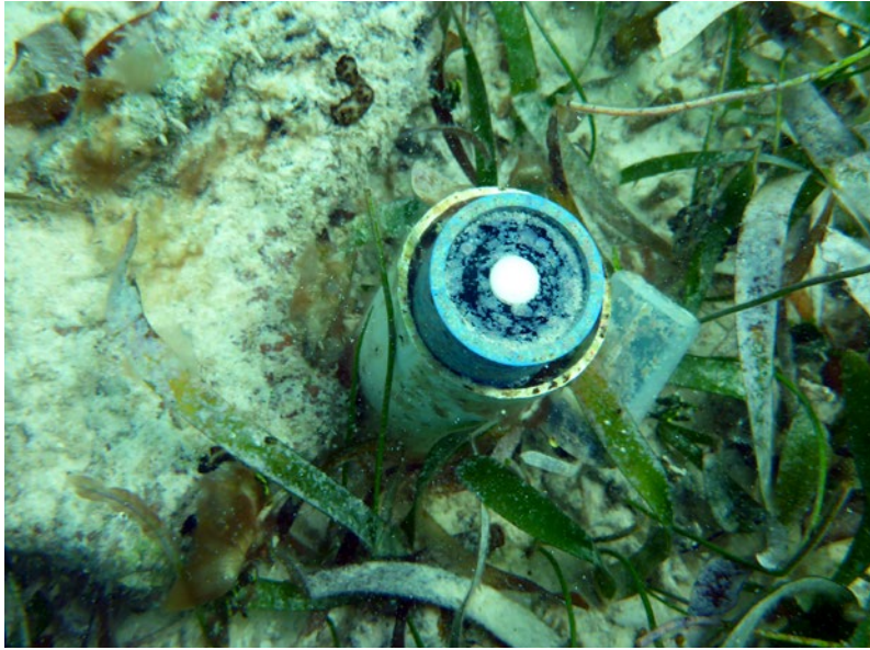
Figura 3.11 Sensores permanentes (Odyssey y Hobo) utilizados para el monitoreo de variables abióticas en pastizales marinos. FOTO: ISIS MARTÍNEZ LÓPEZ/ICML
