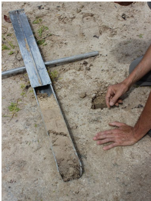
Figura 4.8 Extracción de sedimentos con un nucleador para el cálculo de nutrientes del manglar. FOTOS: EDGAR VILLEDA/CONABIO
