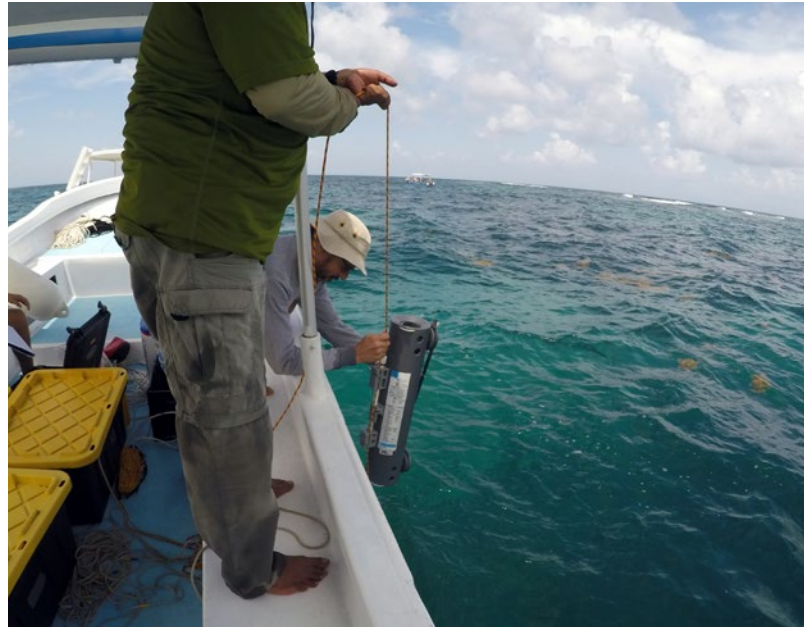
Figura 2.19 Utilización de la botella Niskin para la toma de muestras de nutrientes en arrecifes coralinos. FOTO: SERGIO CERDEIRA ESTRADA/CONABIO
