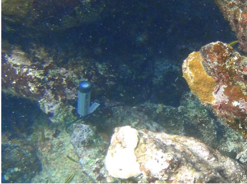
Figura 2.16 Sensor permanente para el monitoreo de temperatura en los arrecifes coralinos. FOTO: SERGIO CERDEIRA ESTRADA
