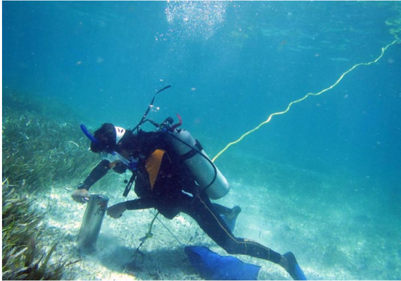
Figura 3.5 Empleo del nucleador para la toma de muestras de sedimentos en pastizales marinos. FOTO: BRIGITTA I. VAN TUSSENBROEK/ICML
