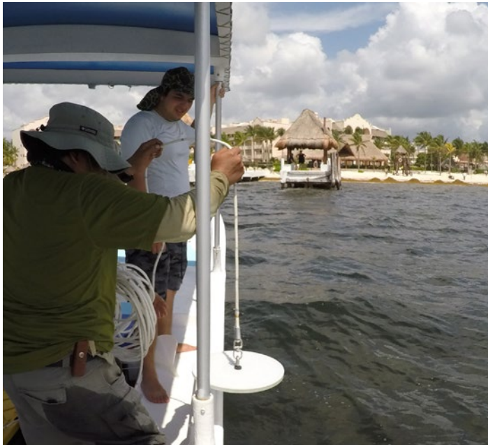
Figura 2.18 Disposición del disco Secchi tipo oceanográfico.
