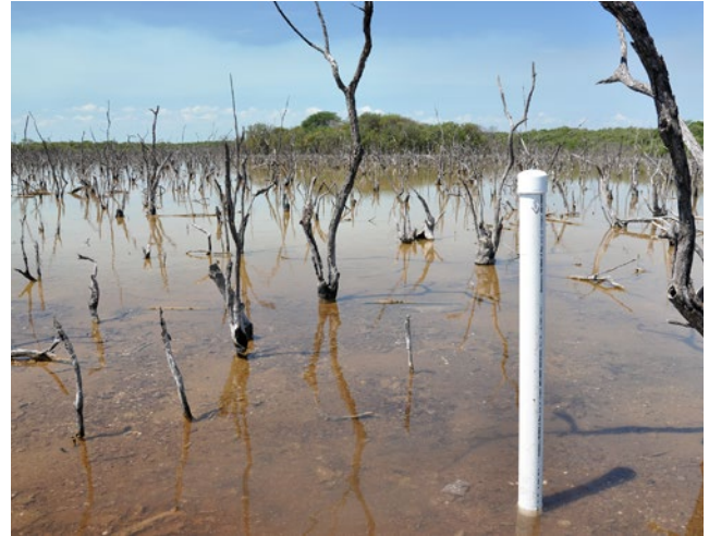
Figura 4.2 Ubicación del sensor permanente dentro de un tubo de PVC para la medición de variables abióticas en el manglar. FOTO: ARTURO ZALDÍVAR JIMÉNEZ/CONABIO
