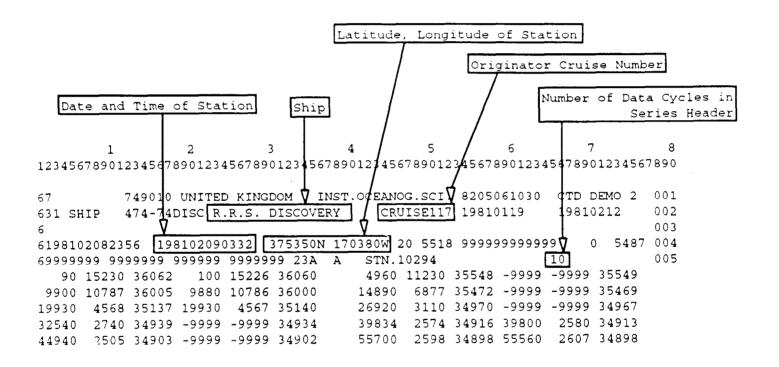
FIGURE 5. TAPE DUMP OF SERIES HEADER RECORD - GF3 STANDARD SUBSET FOR CTD DATA
