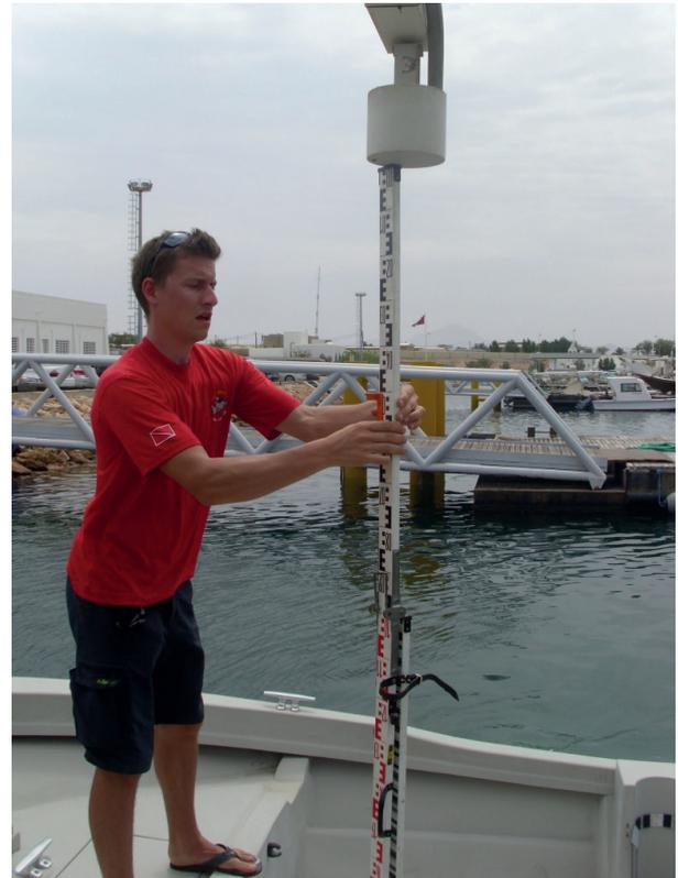
(b) Tipo poco frecuente de nivelación de un medidor de radar indonesio desde una embarcación en condiciones de calma (fotografía: T. Schöne, GFZ).
