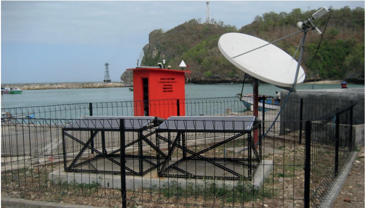
**Figura 7.5** Antena VSAT junto a un mareógrafo en Indonesia. Esta estación también está equipada con un medidor de radar OTT Kalesto y un receptor GPS. (Fotografía: Tilo Schöne, GFZ).
