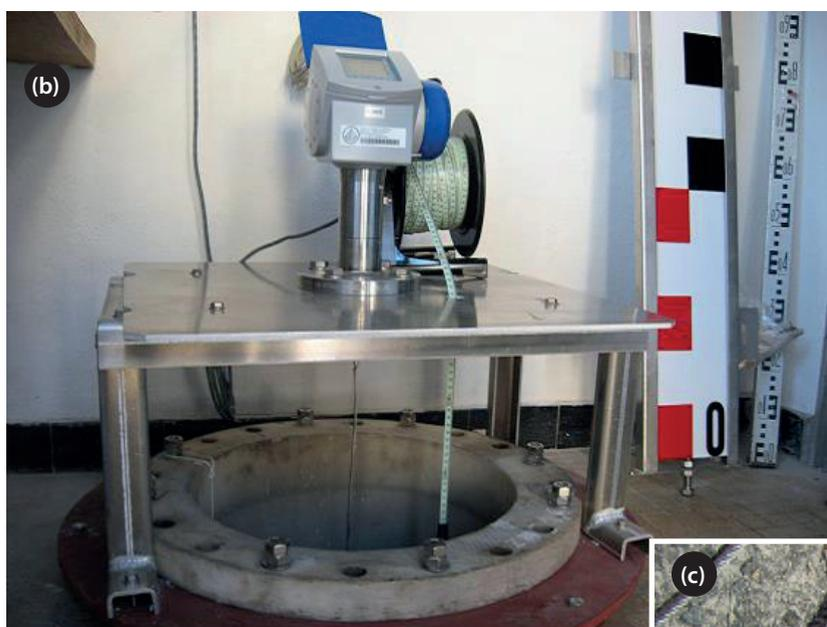
(b) Sensor de radar de onda guiada instalado en un cilindro de amortiguación ubicado en Sète, Francia
