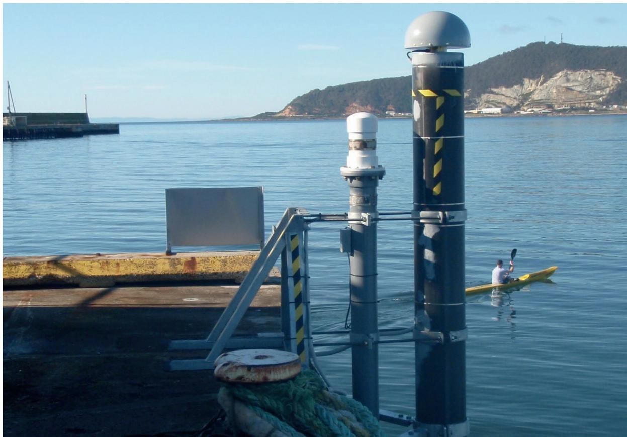
**Figura 6.4** Mareógrafo acústico en Burnie, en el norte de Tasmania (Australia) y, a su derecha, un pilar especial con una antena del GNSS en la parte superior. Fotografía cortesía de Geociencia Australia. (Pugh y Woodworth, 2014).
