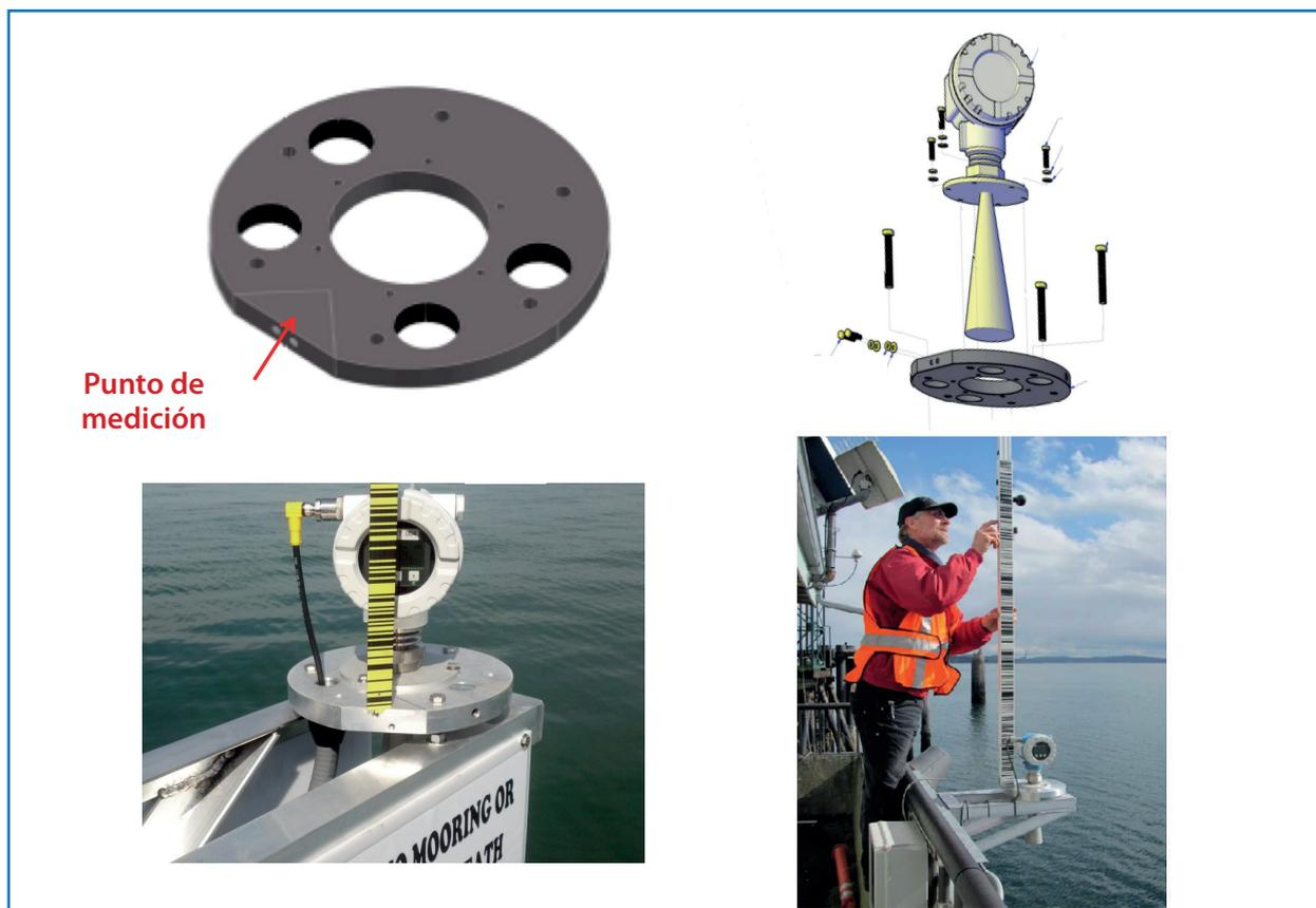
**Figura 4.4** Anillo de montaje utilizado por la NOAA para medidores de radar con antena de bocina Waterlog H-3611. El anillo es un disco de aluminio con un espesor de 1 pulgada y agujeros para acoplar el sensor al anillo y el anillo al soporte. Se puede colocar una vara de nivelación en la zona superior del disco para posibilitar una conexión geodésica con cotas cercanas.
