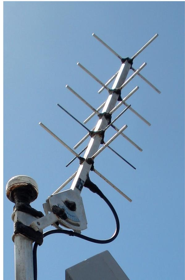
**Figura 7.8** Antena Yagi de GOES. El pequeño hemisferio ubicado en la parte superior del poste de soporte es una antena GPS para el control del tiempo. (Fotografía: NOC).
